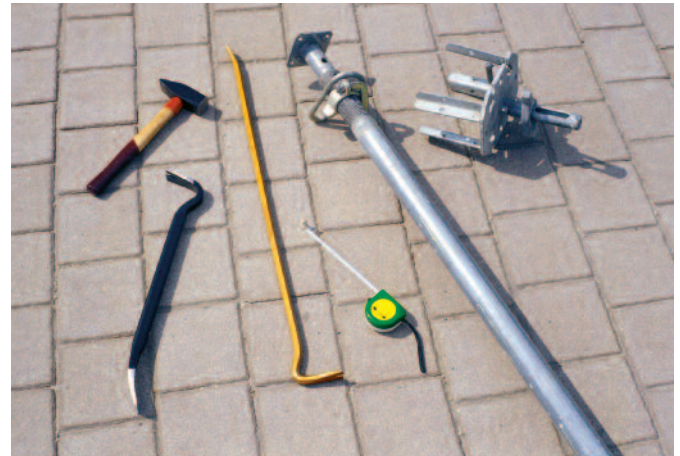
Bild 1: Grundausrüstung von benötigtem Werkzeug und Gerät
